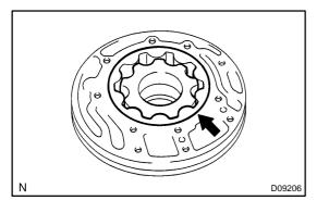
6. REMOVE FRONT OIL PUMP DRIVEN GEAR
