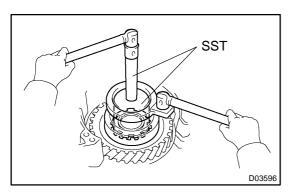
(d) Using SST, install the nut.
