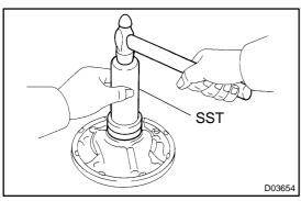
11. INSTALL FRONT OIL PUMP OIL SEAL
