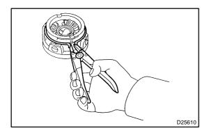
(d) Using a snap ring expander, remove the pinion shaft spacer snap ring.
