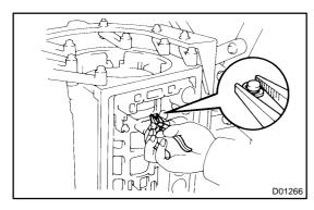
(d) Using a needle nose plier, install the E-ring to the pin.
