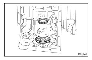
(d) Place the piston return spring onto the No. 2 brake piston.
