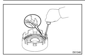
(d) Using a screwdriver, install the snap ring.
