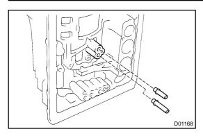
30. REMOVE 2 BRAKE DRUM GASKETS
