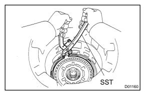
31. REMOVE NO. 1 ONE-WAY CLUTCH MULTIPLE DISC BRAKE AND FRONT PLANETARY GEAR
