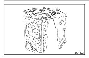
INSTALL TRANSMISSION CASE ON OVERHAUL AT-**TACHMENT**
