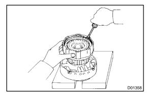
(d) Install the snap ring with a screwdriver.
