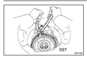
(d) Using SST, install the snap ring. SST 09350-30020 (09350-07060)
