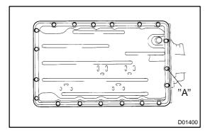
(d) Install and torque the 19 bolts.
