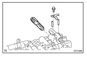
19. REMOVE SHIFT SOLENOID VALVE SL2
