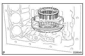
(d) Place the piston return spring onto the brake piston No.4.
