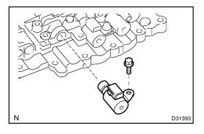
14. INSTALL SHIFT SOLENOID VALVE S1
