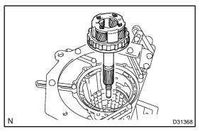
(d) Install the rear planetary gear assy.
