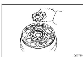
5. REMOVE OIL PUMP DRIVE AND DRIVEN GEARS
