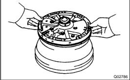
1. USE TORQUE CONVERTER CLUTCH AS WORK STAND
