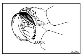
3. CHECK OPERATION OF ONE-WAY CLUTCH
